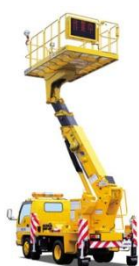
トンネル点検車
