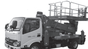
トンネル点検車
