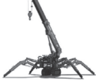
カニクレーン
