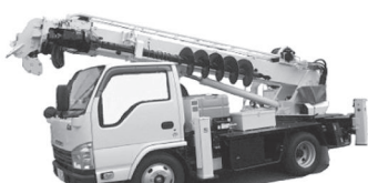
穴掘り建柱車
