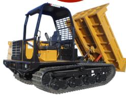
後進運転時の快適な操作をサポートする回転式リバースシート搭載。ワンタッチレバーで容易に回転可能
