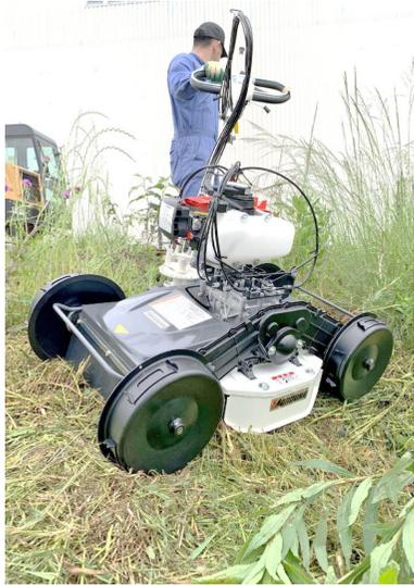
自走式だから押す必要もなく、作業者の負担軽減、省力化につながります。手を離せばクラッチが切れて走行を停止。安全安心の作業が実現します。
