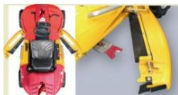
密集した草を刈る時、草の吐き出しを良くし刈り取り負荷を抑える為、刈刃カバーの後方を密集度に応じて3段階に広げることができます。刈った草がカバー内に溜まることなく、スムーズに後方開口部より吐き出されますので、刈り後も綺麗にしかもスピーディーに作業が行えます。更に、刈った草が片側に寄せられますので、集草作業も効率的です。また、刈刃カバーサイドは閉じたままですと、異物の直接飛散を防止、危険性が低減されます。
