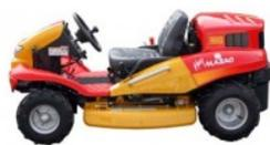
燃料タンクを車体前後中心に配置することにより、燃料残量に関係なく、前後の車重バランスが常に安定。斜面での前輪浮き上がり防止とともに、確実な路面グリップ力により安定した走行を体感していただけます。
