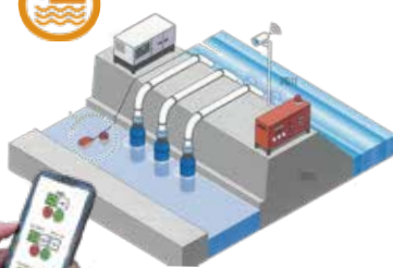
人に依存したポンプ設備の運用管理から IoTを活用した遠隔一元管理へ 遠隔始動排水システム
