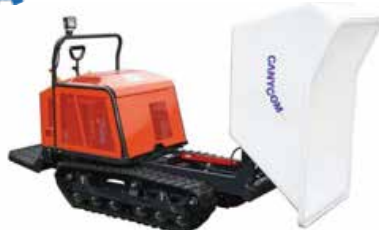
生コン専用運搬クローラキャリア コンクリート砂男 (SC75)
