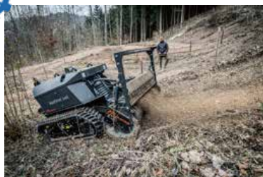
最大100メートル離れた場所から 遠隔操作できる切株切削機(マルチャー) ラプター100
