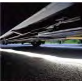
整備車両の床面からの照明
