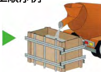
コンクリート打設
